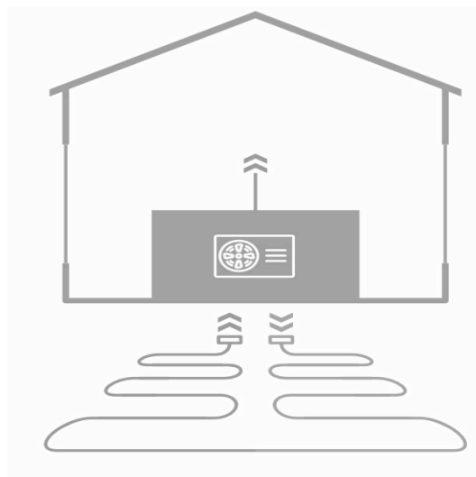
C - BODEM / WATER (HORIZONTAAL)
